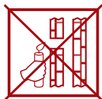
недостаточная тяга (Не используйте котел!)
