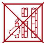
слабая тяга (Не используйте котел!)
